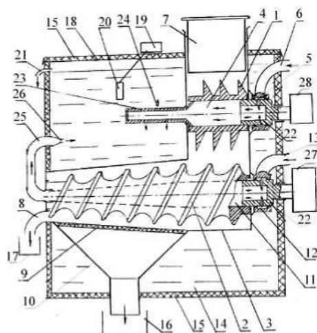
Устройство содержит размельчитель 1 и комбинированный шнек 2, установленные в корпусе 3. Размельчитель выполнен в виде горизонтального цилиндра, снаружи которого радиально расположены по винтовой линии заостренные штифты, а внутренняя полость 4 размельчителя соединена через проточку 5 в подшипнике корпуса 3 с паропроводом 6. В
