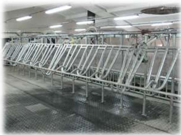
Рисунок 1.12 – Общий вид станочного оборудования с системой быстрого выхода
