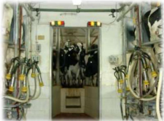
Рисунок 1.29 – Световая сигнализация доильного зала
