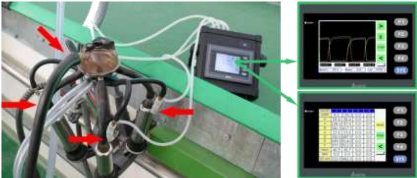
Рисунок 4.2 – Точка подсоединения прибора для измерения пульсаций в доильном аппарате
