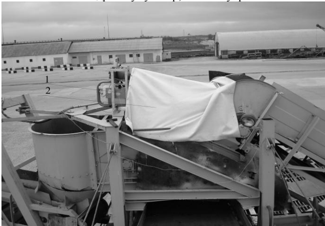
Рисунок 50 – Установка аэрозольного генератора Условные обозначения: 1 - Аэрозольный генератор; 2 - защитный кожух
