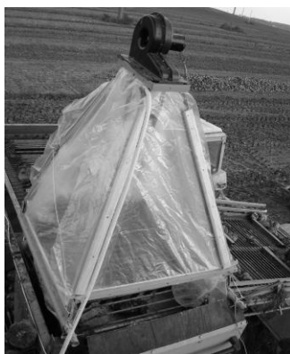
Рисунок 42 – Камера протравливания, установленная над циркуляционным элеватором свеклоуборочного комбайна.
