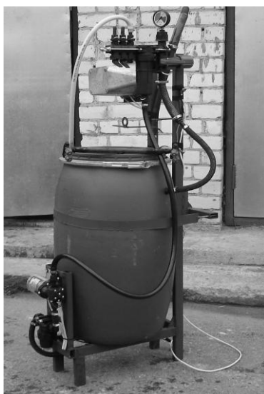
Рисунок 44 – Модуль дозирования раствора.
