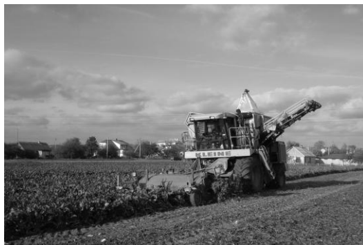
Рисунок 41 – Общий вид свеклоуборочного комбайна с приспособлением для обработки корнеплодов сахарной свеклы жидким защитным препаратом.
