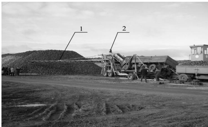
Рисунок 45 – Буртоукладчик при отборе образцов Условные обозначения: 1- стрела погрузочного транспорта; 2 – аэрозольная установка.
