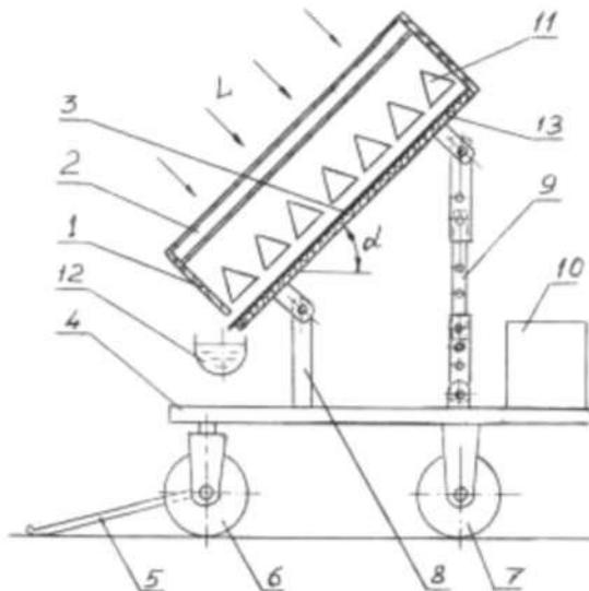
Нижняя часть наклонного корпуса 1 воскотонки соединена по краям шарнирно через невысокие стойки 8 с задней частью рамы 4 тележки, а возвышающаяся часть корпуса воскотонки имеет посередине телескопическую опору 9 с возможностью её фиксации по высоте.
