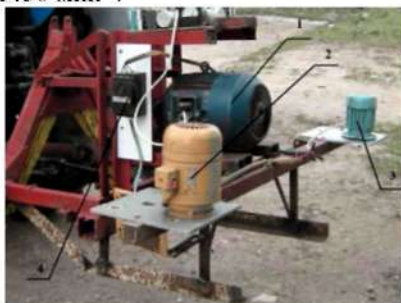
1 – асинхронный генератор; 2, 3 – электродвигатели; 4 – пускатель
