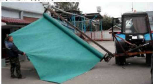
Рисунок 4 – Опытный образец размотчика рулонов укрывочного материала
