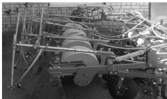
Рисунок 5 – Опрыскиватель с телескопическими секциями в составе агрегата для междурядной обработки АУ-М2, вид сбоку
