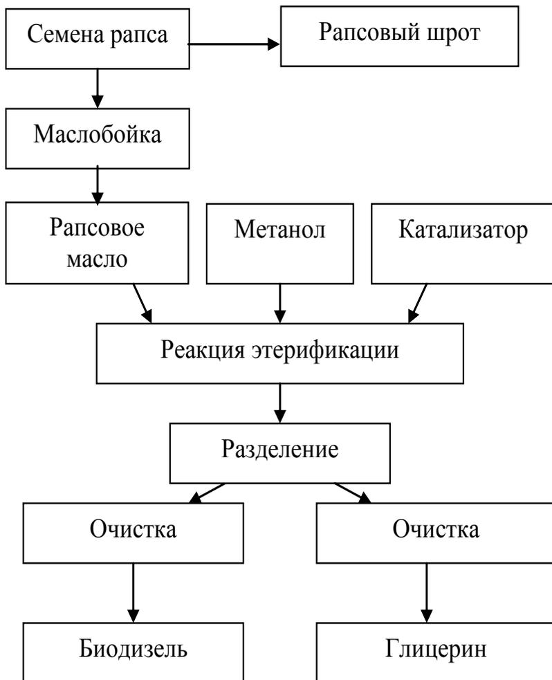
*Рисунок 1.4 – Схема производства биодизеля из семян рапса*
