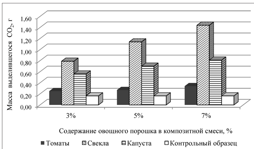
Рисунок 2 – Суммарное выделение углекислого газа за период брожения теста после добавления муки
