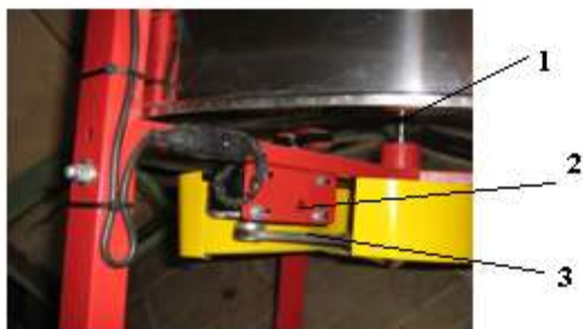
1 – вал ротора; 2 – электродвигатель; 3 – клиноремennая передача
