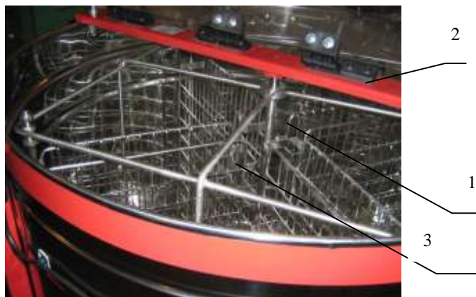
1 – вал ротора; 2 – поперечина с верхним подшипником; 3 – поворотная кассета с размещенной в ней сотовой рамкой
