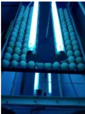
Рисунок 1 – Обработка инкубационных яиц ультрафиолетовым излучением С-спектра на экспериментальной установке
